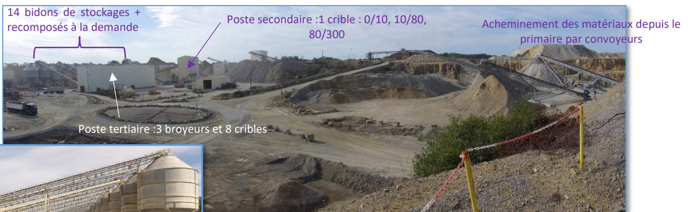
7 : F – Vue sur la chaîne de production
